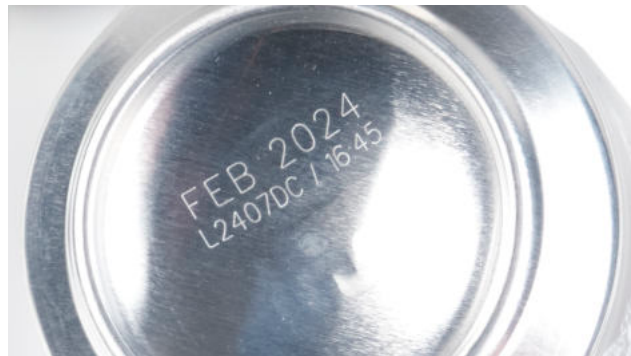
Lasergravierte Datums- und Chargencodes.
