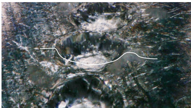
Analyse der Eindringtiefe in das Produkt entlang eines Punktes.
