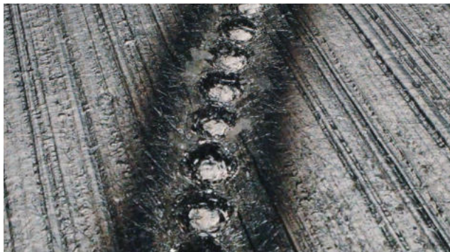
Eine mikroskopische 3D-Aufnahme zeigt einzelne gravierte Punkte.
