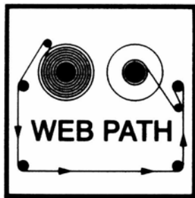
Recorrido de la banda de la V100
