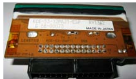
Sustitución del cabezal de impresión
