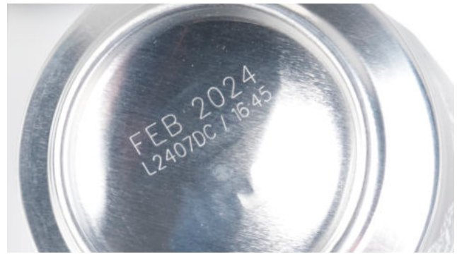
Met laser gegraveerde datum- en lotcode.
