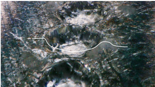
Diepteanalyse van doordringing op het product langs één dot.
