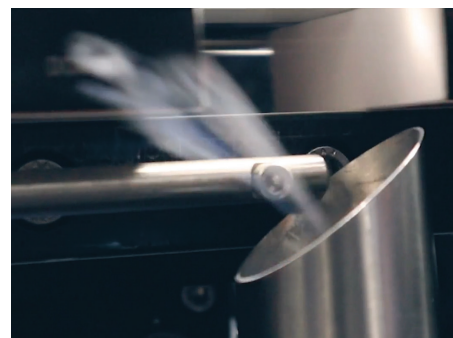
Les systèmes d'extraction de fumée DPX de Domino filtrent efficacement les fumées et particules générées lors du processus de codage.
