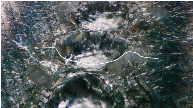
Analyse de la profondeur de pénétration du produit le long d'un point.
