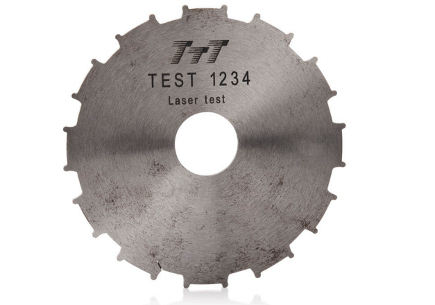
Vous pouvez produire des codes sombres sans graver le métal en utilisant un effet de recuit
