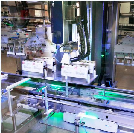
Die Kennzeichnung erfolgt in 4er-Einheiten (zwei rechts und zwei links des Schlittens) bei bis zu maximal 45.000 Flaschen bzw. 7.500 Sixpacks pro Stunde, bevor diese in der nachgeschalteten Meypack Verpackungsmaschine jeweils einer Tray-Verpackung zugeführt werden.
