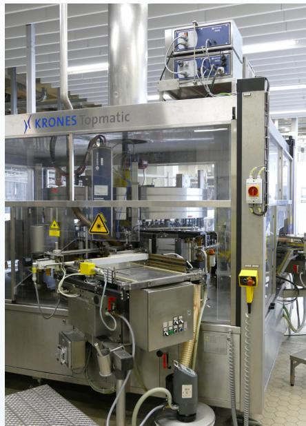
Realisiert wird dies bei Bitburger durch die Integration von drei **D620i** Laser-Codierern (IP 65), die innerhalb von Krones Topmatic Etikettiermaschinen die notwendige zweizeilige Kennzeichnung per Farbabtrag auf die Rückenetiketten der 0,33 l und 0,5 l Bierflaschen bei einer Geschwindigkeit von bis zu 55.000 Flaschen pro Stunde aufbringen.
