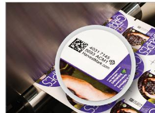
Código QR impreso sobre embalaje con el equipo K600i de Domino integrado en una rebobinadora
