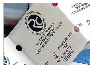
Número de corte y apilado añadido a los tickets preimpresos en una aplicación flexográfica de banda estrecha, impreso con un equipo de la Serie A de Domino
