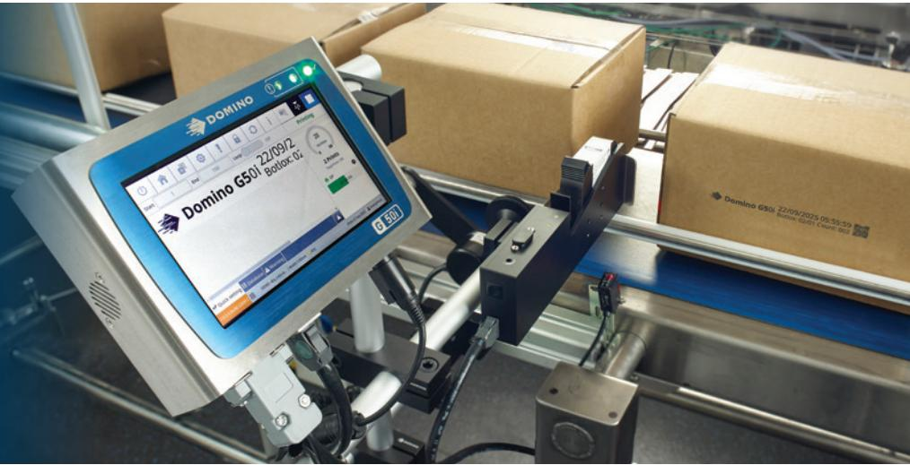
Le modèle **G50i** est notre imprimante jet d'encre thermique (TIJ) d'entrée de gamme. Elle constitue l'option idéale pour les clients à la recherche d'un système facile à utiliser pour le codage de base des produits et des caisses et cartons.
